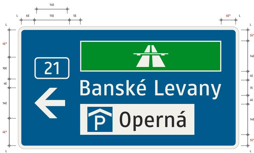
V prípade potreby je možné použiť šírkovo úsporné usporiadanie tabuľových smerníkov. Oproti základnému usporiadaniu je možné vykonať nasledujúce úpravy:
