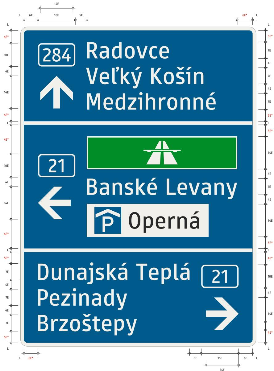
Šírkovo úsporné usporiadanie kompaktného formátu je analogické k šírkovo úspornému usporiadaniu rozdeleného formátu tabuľového smerníka.
