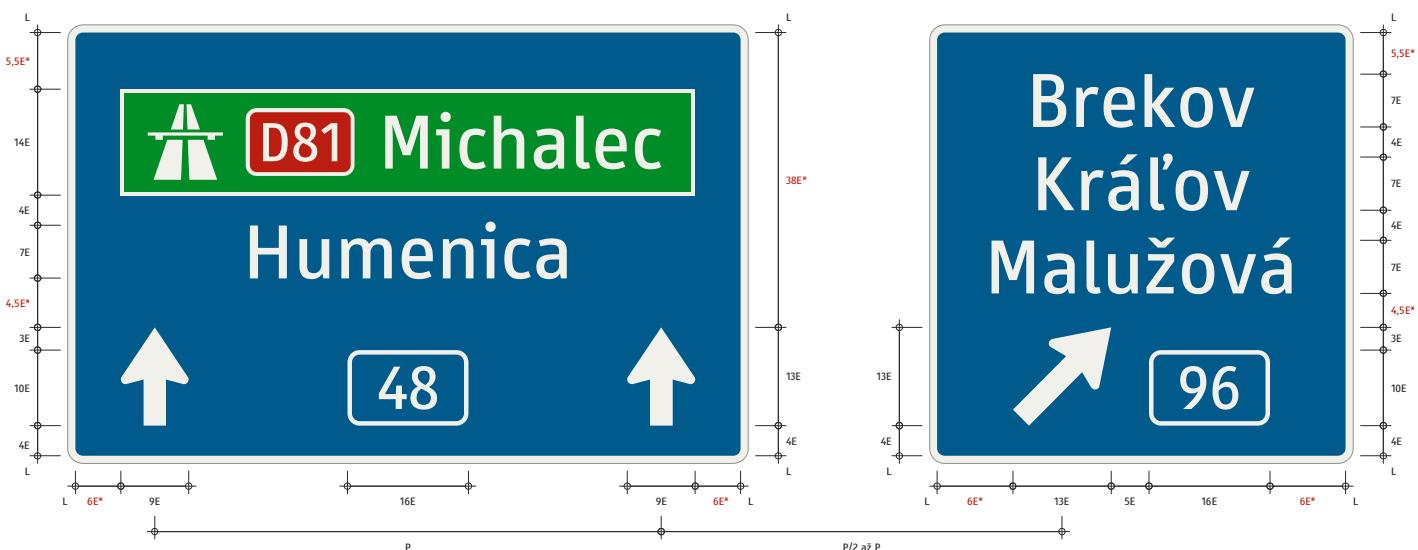
Variant značky pri umiestnení na portáli s vyznačením radenia do jazdných pruhov. Umiestnenie v mieste plného rozvinutia odbočovacieho pruhu, resp. pri subtrakcii v mieste, kde by bol odbočovací pruh plne rozvinutý, ak by nešlo o subtrakciu jazdného pruhu.
