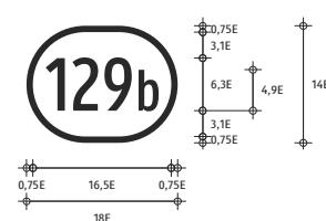
Čísla prípojok a uzlov sa uvádzajú podľa vzorov vyššie. Vzdialenosť sa uvádza k prvej návesti (VL 373) a vyobrazuje sa v písme výšky 6,3 E, t.j. 90% základnej výšky písma.
