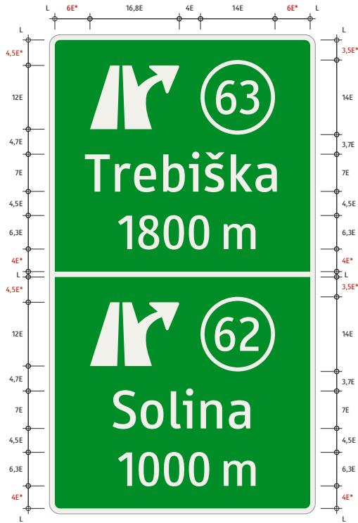
Pri krátkej vzdialnosti medzi odbočeniami (prípojka, uzol, odpočívalo) z diaľnice možno dvojicu odbočení po sebe ohlásiť jednou spoločnou ohlasovacou tabuľou.
