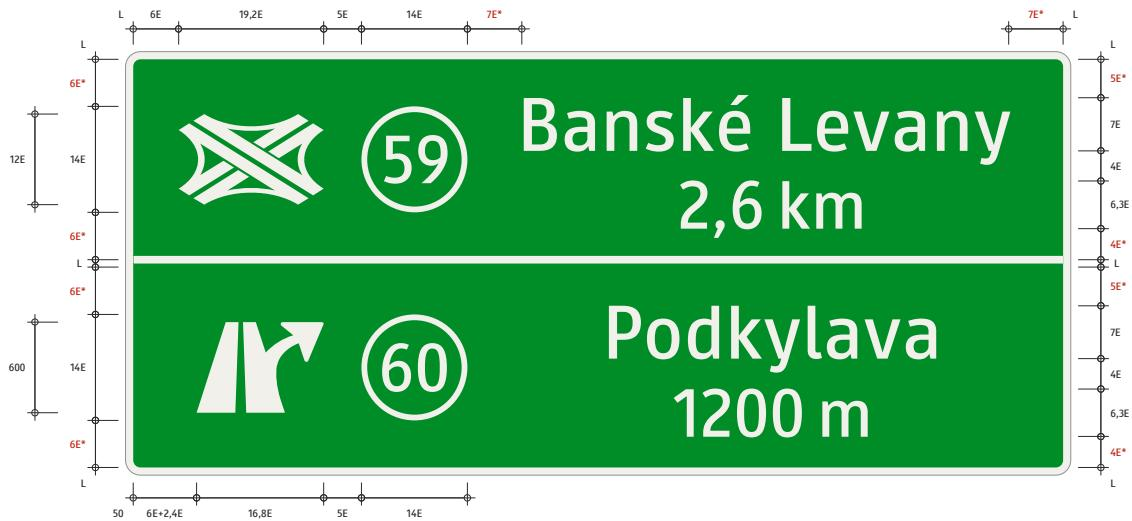
Pri výškovom umiestnení dvojitej ohlasovacej tabule sa s ohľadom na dosiahnutie primeranej výšky značky presúvajú identifikačné údaje (typ a číslo uzla/prípojky, resp. druhy služieb na odpočívadle) vľavo od názvu odbočenia a vzdialenosť k prvej návesti.
