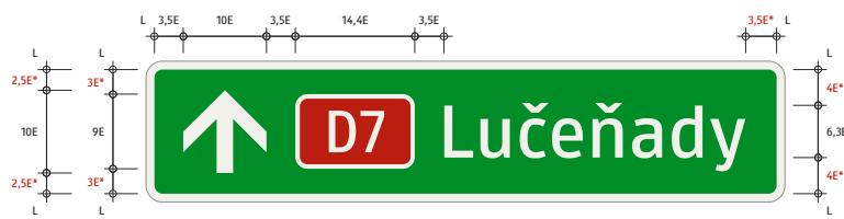
Za účelom navigácie z odpočívadla späť na diaľnicu sa umiestňujú tabuľové smerníky na miestach jednotlivých rozdelení spojovacích ciest vedúcich od objektu čerpacej stanice alebo z parkovacích miesta v smere na diaľnicu. Použitie značiek je dôležité najmä na jednostranných odpočívadlach obsluhujúcich oba jazdné pásy diaľnice, kedy slúžia aj na rozlíšenie smeru diaľnice. Výška písma aj veľkosť čísla diaľnice je zmenšená na 90 %.
