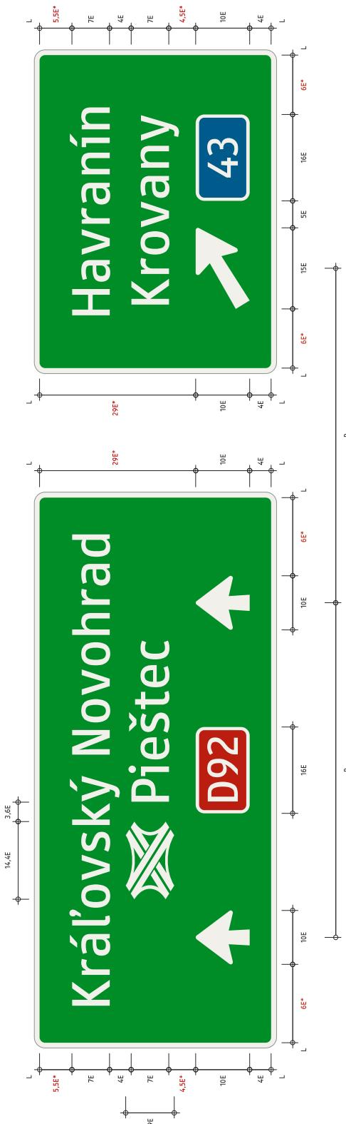
Tabuľa je možné primerane rozšíriť za účelom vloženia veľmi dlhých názvov cielov resp. dvoch cielov vedľa seba; šípky sa potom zodpovedajúco umiestnia tak, aby boli dodržané rovnomenné vzdialenosť a ich správne umiestnenie nad jednotlivými jazdnými pruhmi.
