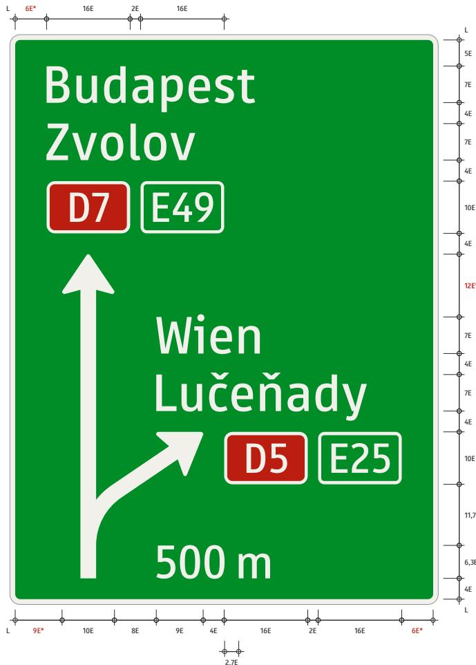
Variant s uvedením čísel E-ciest je z hľadiska rozvrhnutia prvkov analogický s VL 372-53, používa sa však spravidla viac cieľov v priamom smere (diaľkové ciele).
